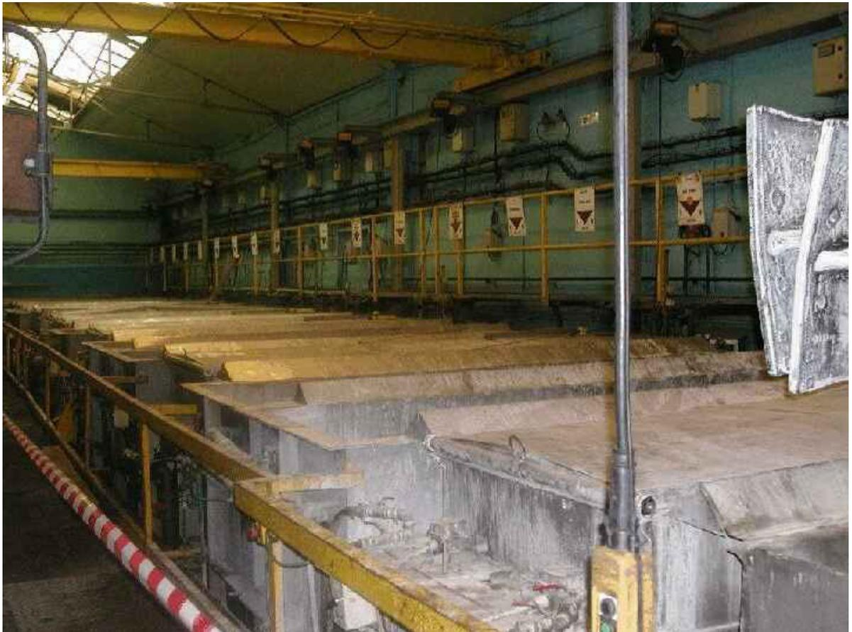
Les cuves de traitement sont alignées et desservies par un pont roulant qui transporte les pièces à traiter dans des paniers pour les pièces peu encombrantes ou des supports spécifiques pour les longues pièces. Durant le process, les cuves de traitement sont couvertes et reliées à un collecteur unique alimentant 4 cheminées pourvues chacune d'un groupe d'aspiration de 24 000 m<sup>3</sup>/h.
